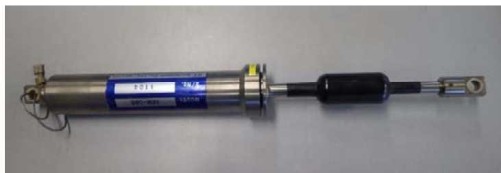
電磁流速計 (JFEアドバンテック社)
