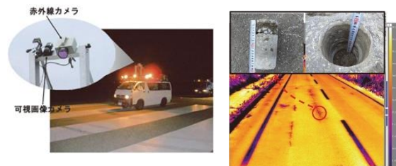
写真 3.5 熱赤外線調査における調査車および解析画像例
