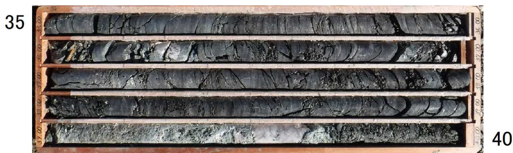
No.2 孔 35～40m コア写真
