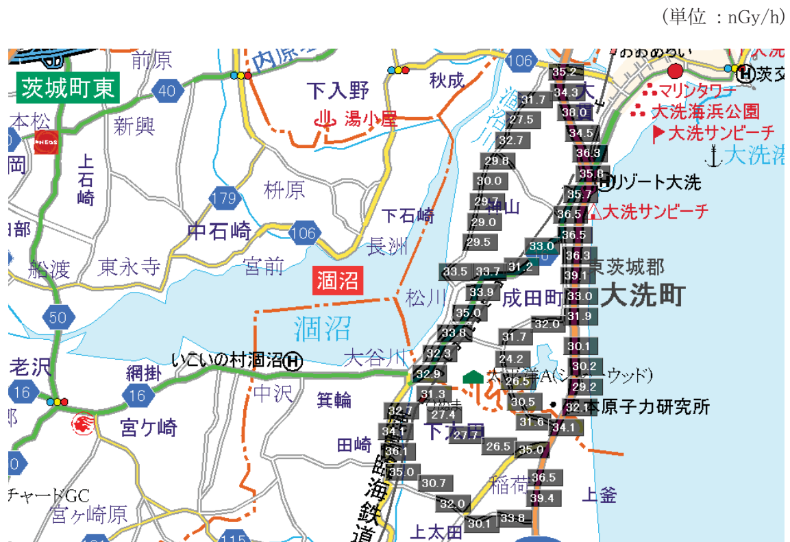
図6 大洗地区走行サーベイ(平成 23 年 2 月)
