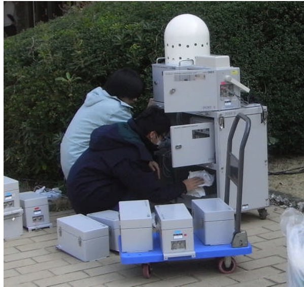
可搬型モニタリングポストの設置（於：北茨城市役所）
