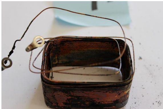
図 15 二次側巻線の状況
