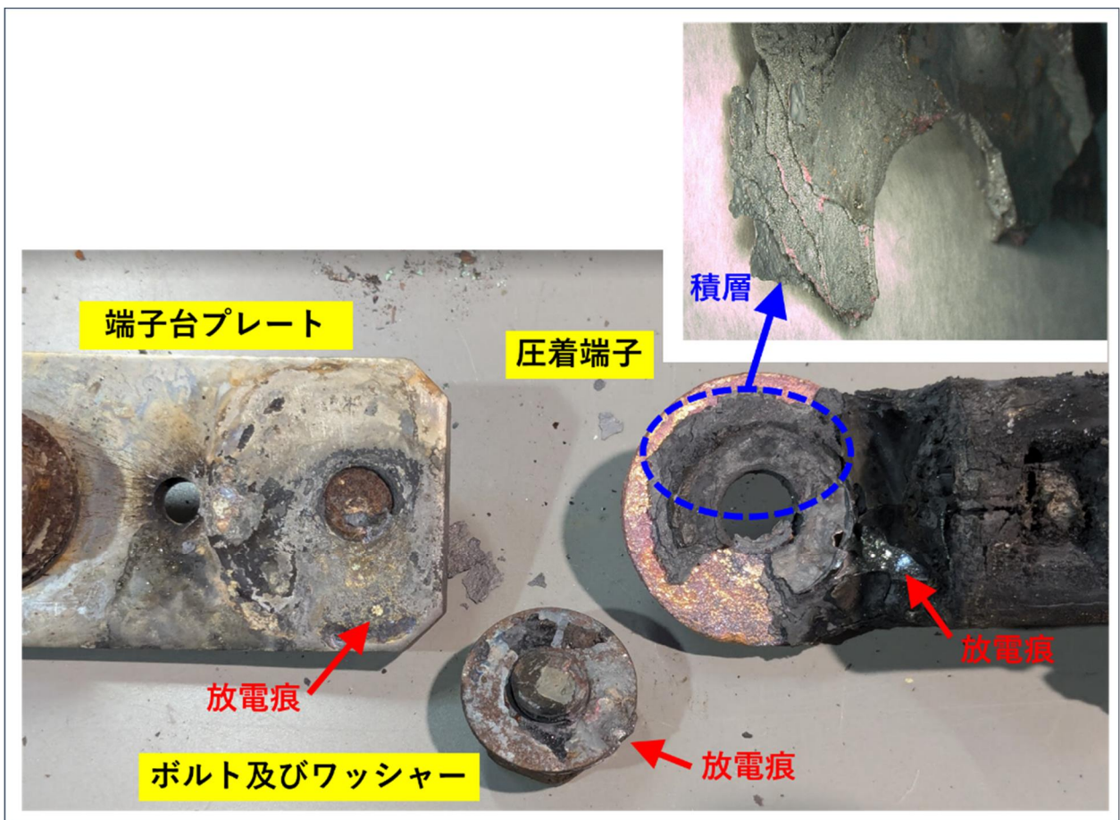
図11 端子台プレート、圧着端子、ボルトおよびワッシャーの状態
