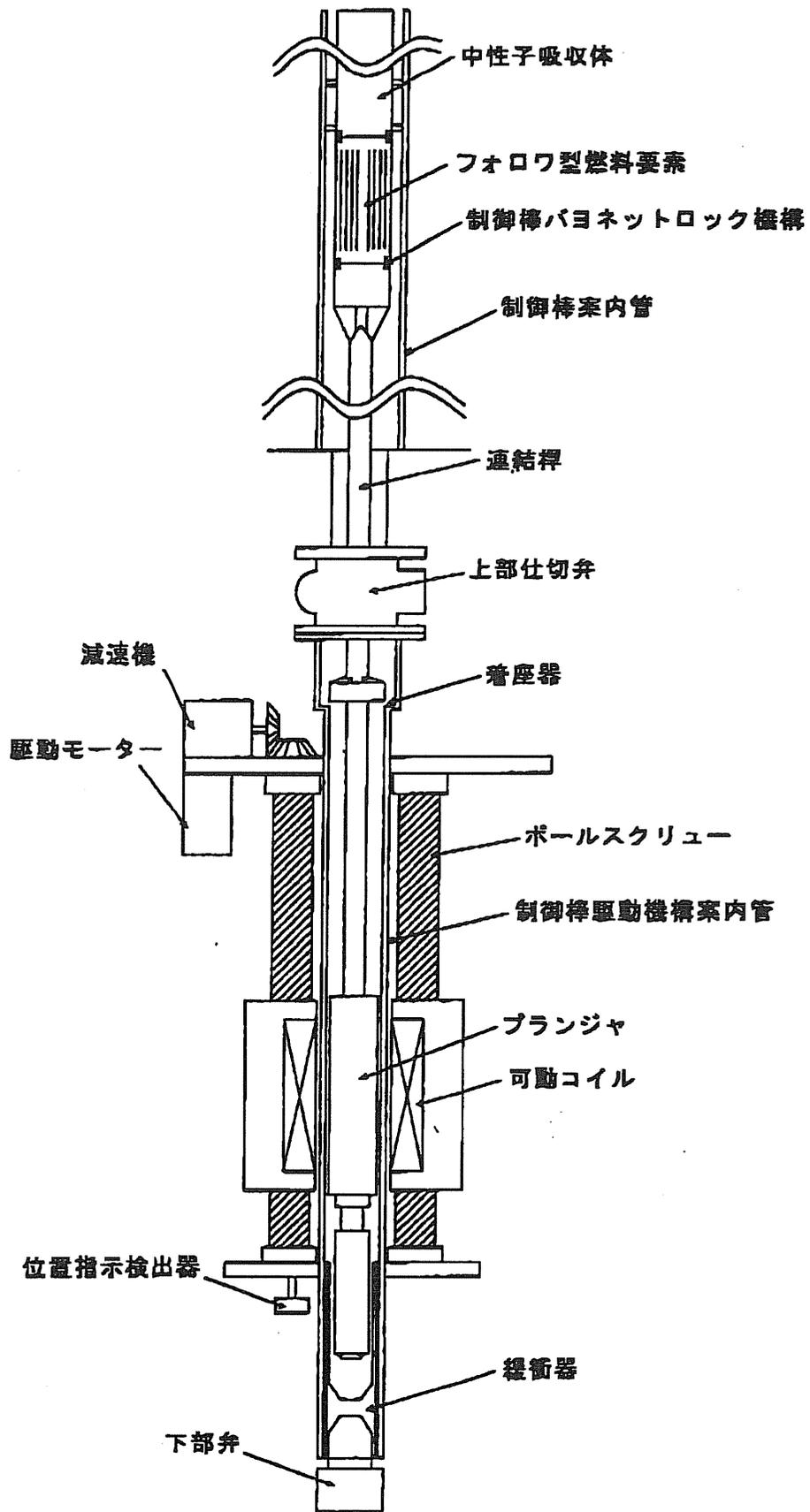
制御棒駆動装置概要図
