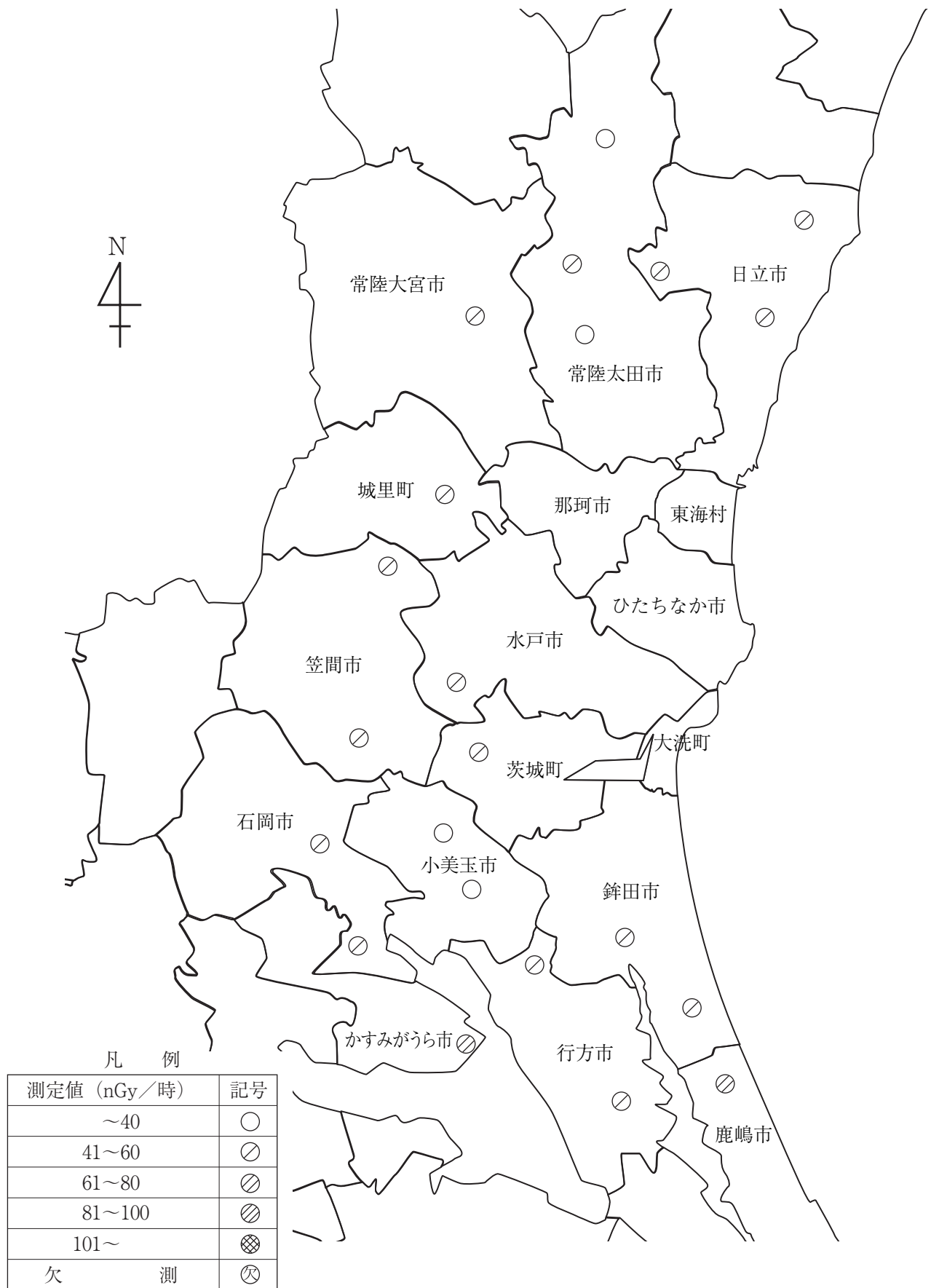
図2 原電又は原子力機構から10~30km圏内地区における空間 \gamma 線量率測定結果(3ヶ月平均値)
