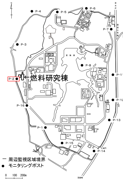
モニタリングポスト配置図 P-2にはβγダストモニタ設置
