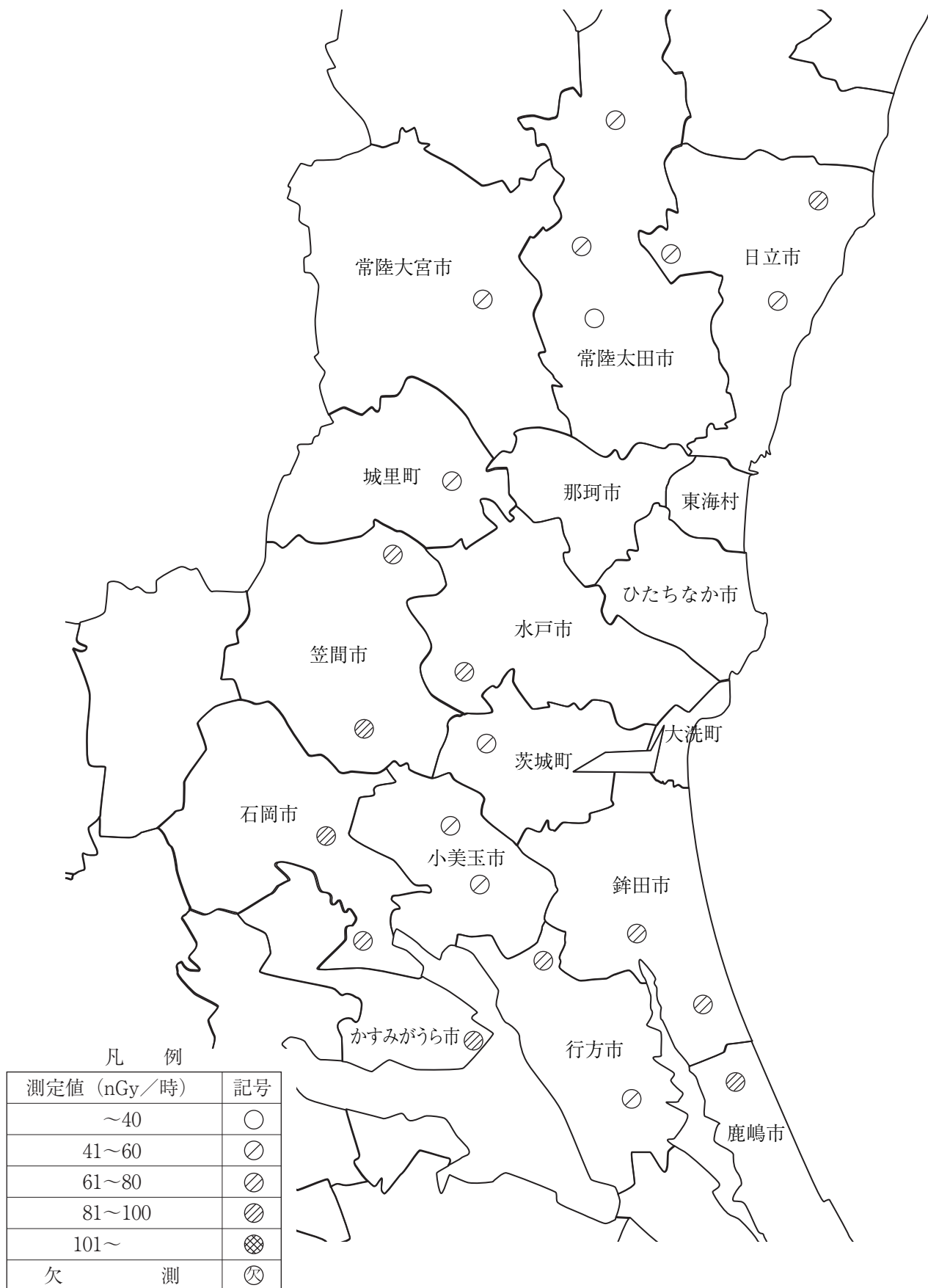
図2 原電又は原子力機構から10~30km圏内地区における空間γ線量率測定結果(3ヶ月平均値)
