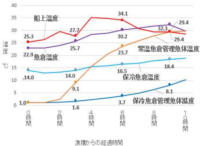
図 1 船上温度と保冷魚倉の温度推移 (R4. 7. 21 海水温 24.1℃)
