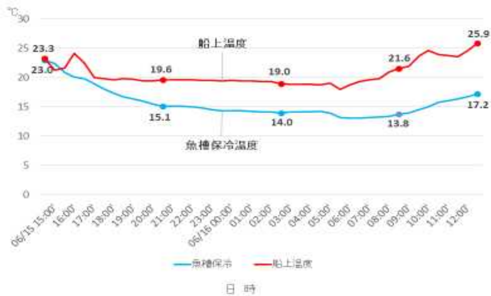
図3 魚槽保冷温度と船上温度の推移 (R3.6.15~16)
