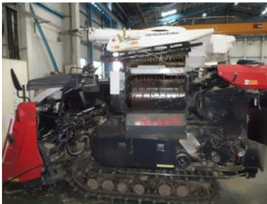
(図2) コンバインの内部を点検
