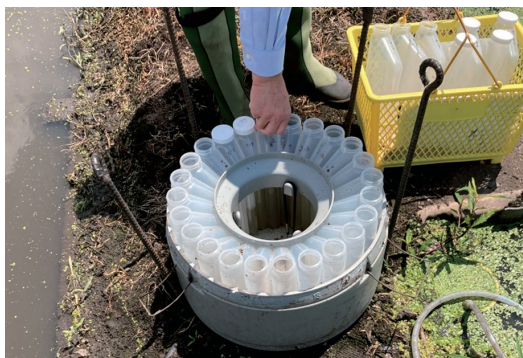
写真 れんこん田面水の自動採水装置
