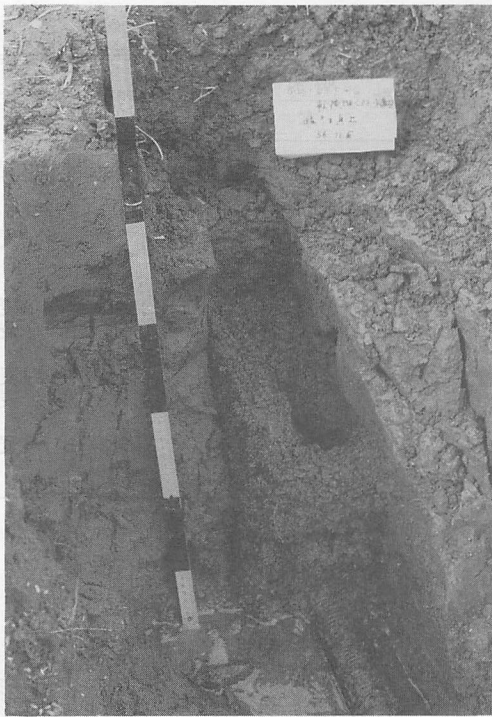
第41図 常陸太田市下河合における本暗渠の状態 (弾丸暗渠との交差部)
