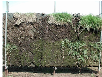
施工 3 ヶ月後（傾斜 90°）
