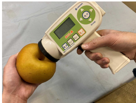
図3 携帯型分光計を用いた果実ていあ部の測定
