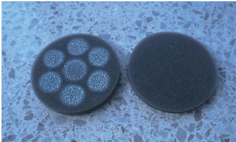
右：使用前 左：使用后、吸引口の位置にホルマリンの重合物が付着している
