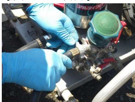
④の余水ホースを、本体横の給水ホース取付口と同じ並びにある取付口にねじ込む。
