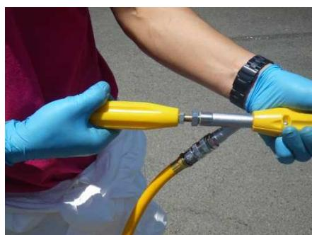
噴霧ノズル手元の握りを回し噴霧範囲を調整し、車両消毒を開始する。
