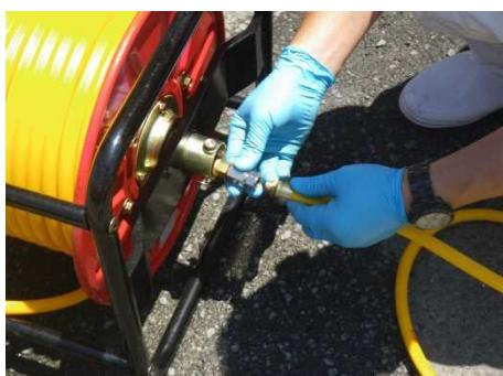
接続ホースの反対側を、⑤の噴霧用ホースリール側面中央分にねじ込む。接続後は、リール側の3本のボルトで固定する。
