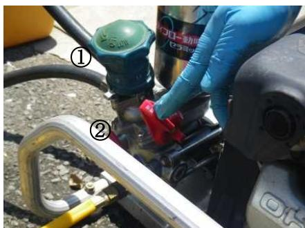
エンジンが始動したら、『余水切替えレバー』を倒し、調圧ダイアルを回し「3.5」程度にする。
