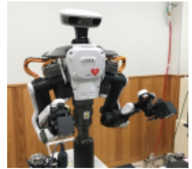
図1 本研究で使用した協働型双腕ロボット
