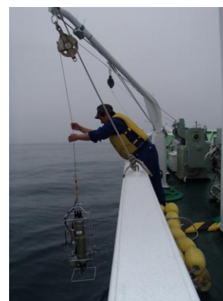
図 1 CTDによる海水温測定
