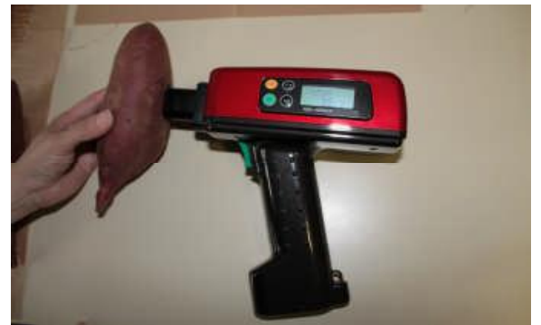
図2 「ベニアズマ」の非破壊測定の様子
