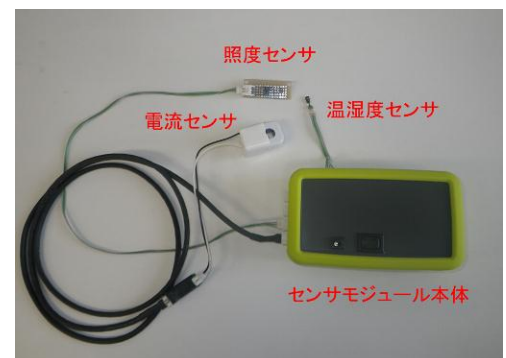
センサモジュールの外観 電流センサ以外も装着可能
