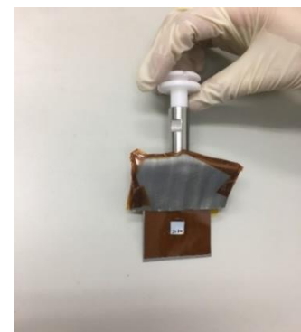
図2 測定試料(太陽電池セルは銀蒸着メッキが白く光った部分)
