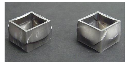
図3 押し角管の軸方向圧縮試験 (左:高強度材, 右:低強度材)
