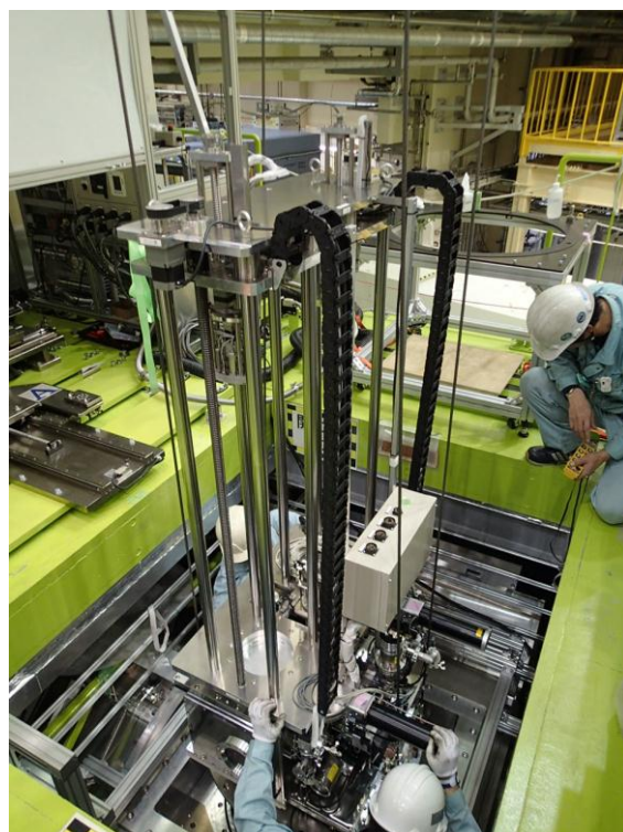
図 1 改良された試料交換搬送機構
