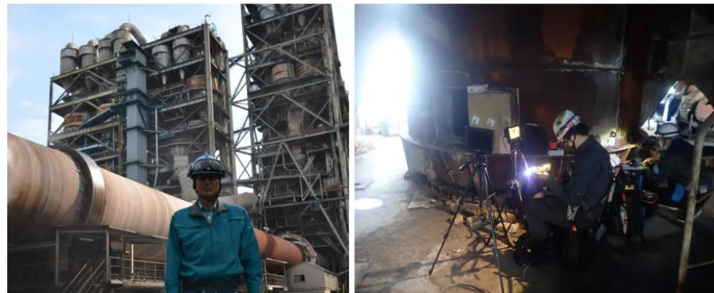
写真左：セメント製造設備と、トクヤマ セメント製造部 設備保全課 松田氏 写真右：点検の様子（奥の内筒をドローンが飛行中。ドローンから送られる映像を見ながら操縦する）
