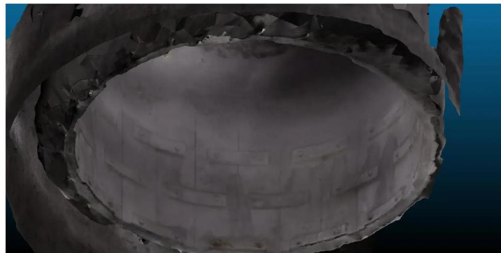
IBISで撮影した映像から生成したサイクロン内部にある内筒の三次元モデル
