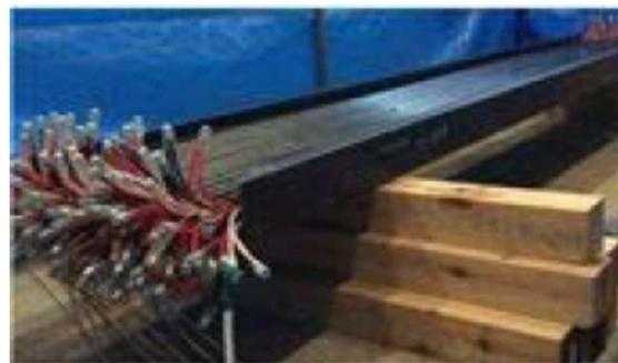
電流低減試験に使用した複合体
