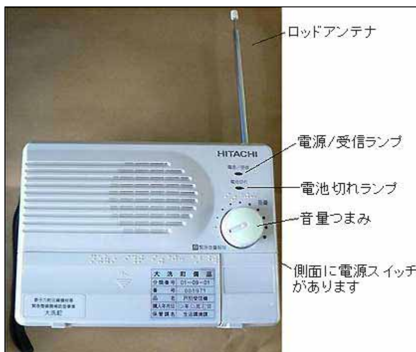
図-6-12.防災行政無線戸別受信機（大洗町 HP より）
