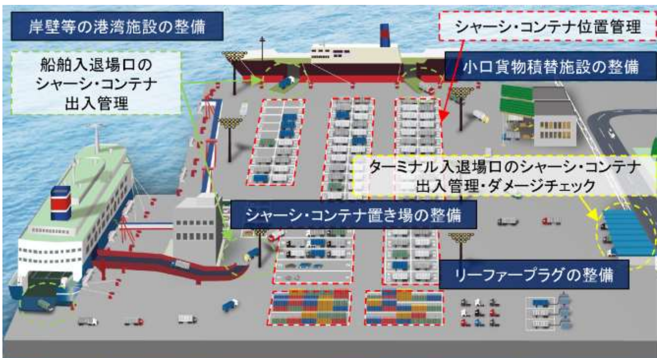
次世代高規格ユニットロードターミナル形成に向けた取組イメージ
