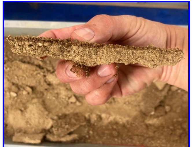
HR散布後の固化層
