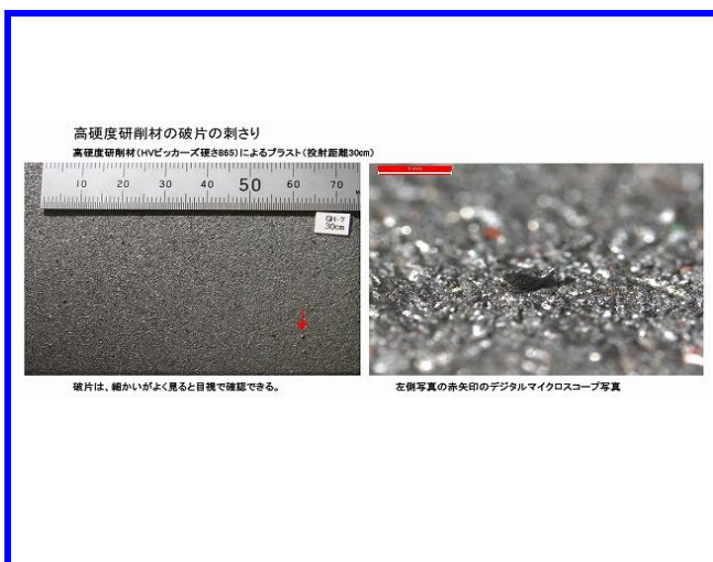
研削材の破片の刺さり(拡大写真)
