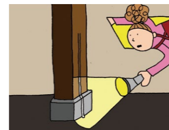
*蟻道、蟻土 シロアリは風を嫌うため、コンクリート等の表面に土と分泌物でトンネルをつくり、その中を移動することがあります。このトンネル状の道を蟻道、同様の塊状のものを蟻土といいます。
