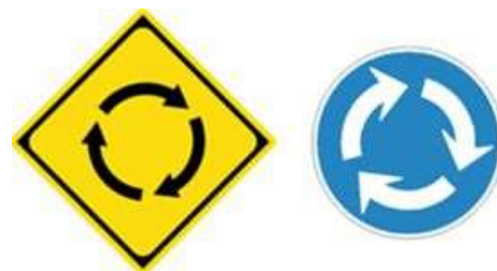
環状交差点 警戒標識（左側）と規制標識（右側）
