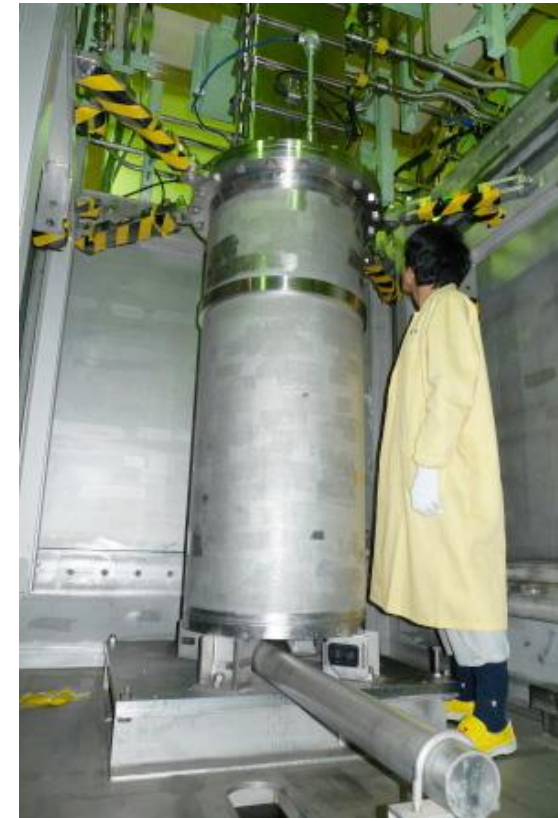
STACY炉心タンク (直径60cm、高さ1.5m)
