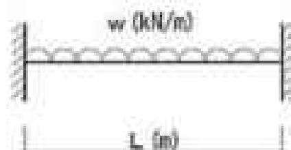
図 5-1-9-1 評価部位 A, C, D, E の応力評価モデル
